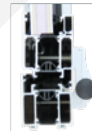
Les vis traversent 2 parois d'aluminium
