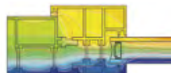
Schéma isothermique de l'intercalaire Warm Edge
